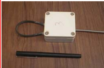
Fig. 1a. Moisture sensor
