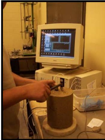
a) FFRC Test Setup
