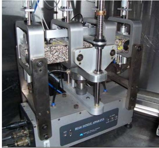
**FIGURE 17 Flexural Fatigue Test Apparatus**
