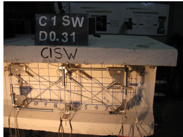
(d) Shear crack pattern before failure
