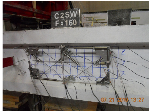
(d) Shear crack pattern before failure
