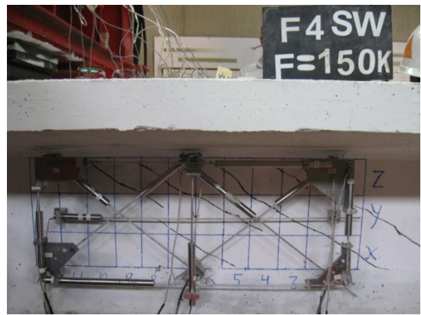
(d) Shear crack pattern before failure
