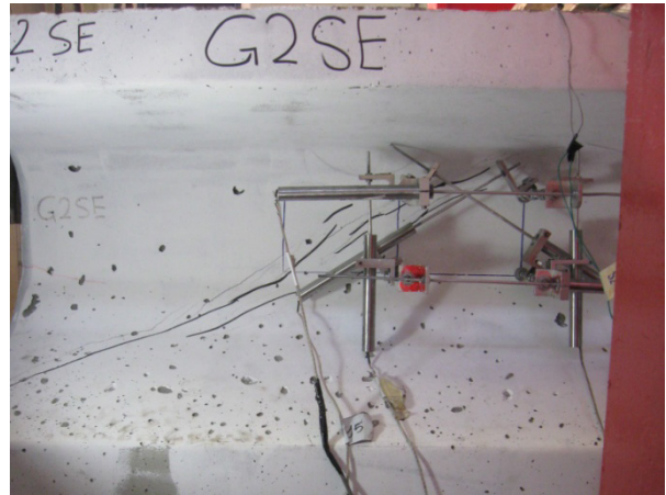
(d) Shear crack pattern before failure
