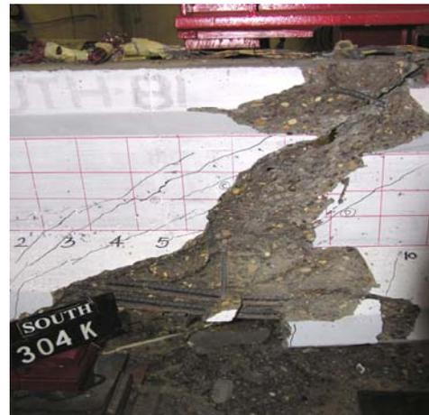
(d) Shear Failure of Beam B1-South End
