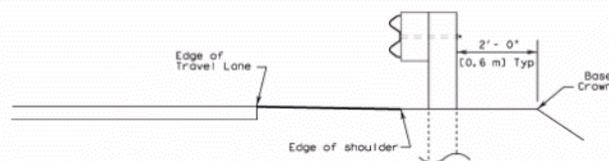
CROWN WIDENING TO ACCOMMODATE GUARDRAIL
