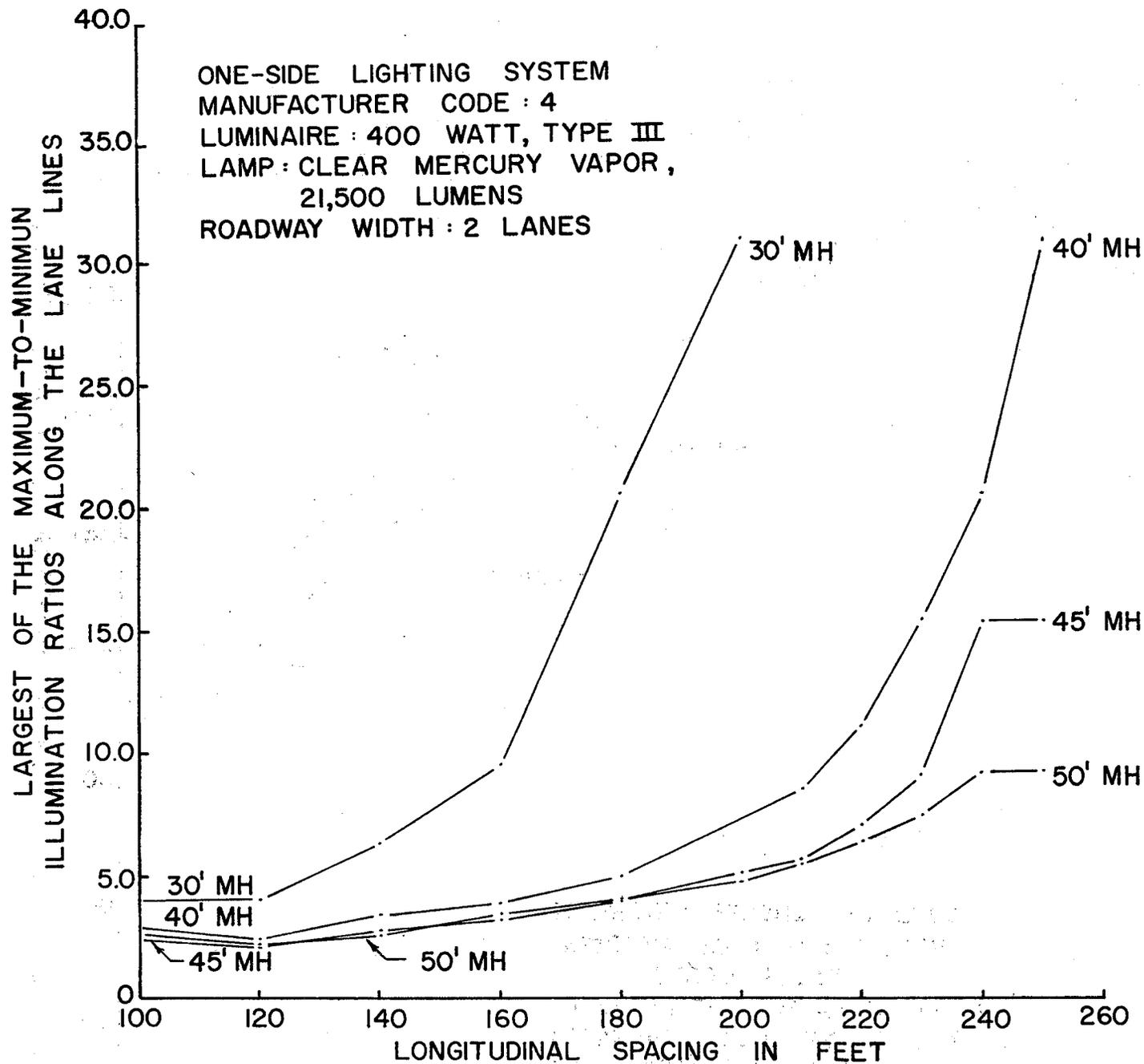
FIGURE 39-RATIO OF MAXIMUM TO MINIMUM ILLUMINATION VS. LONGITUDINAL SPACING FOR DIFFERENT MOUNTING HEIGHTS
