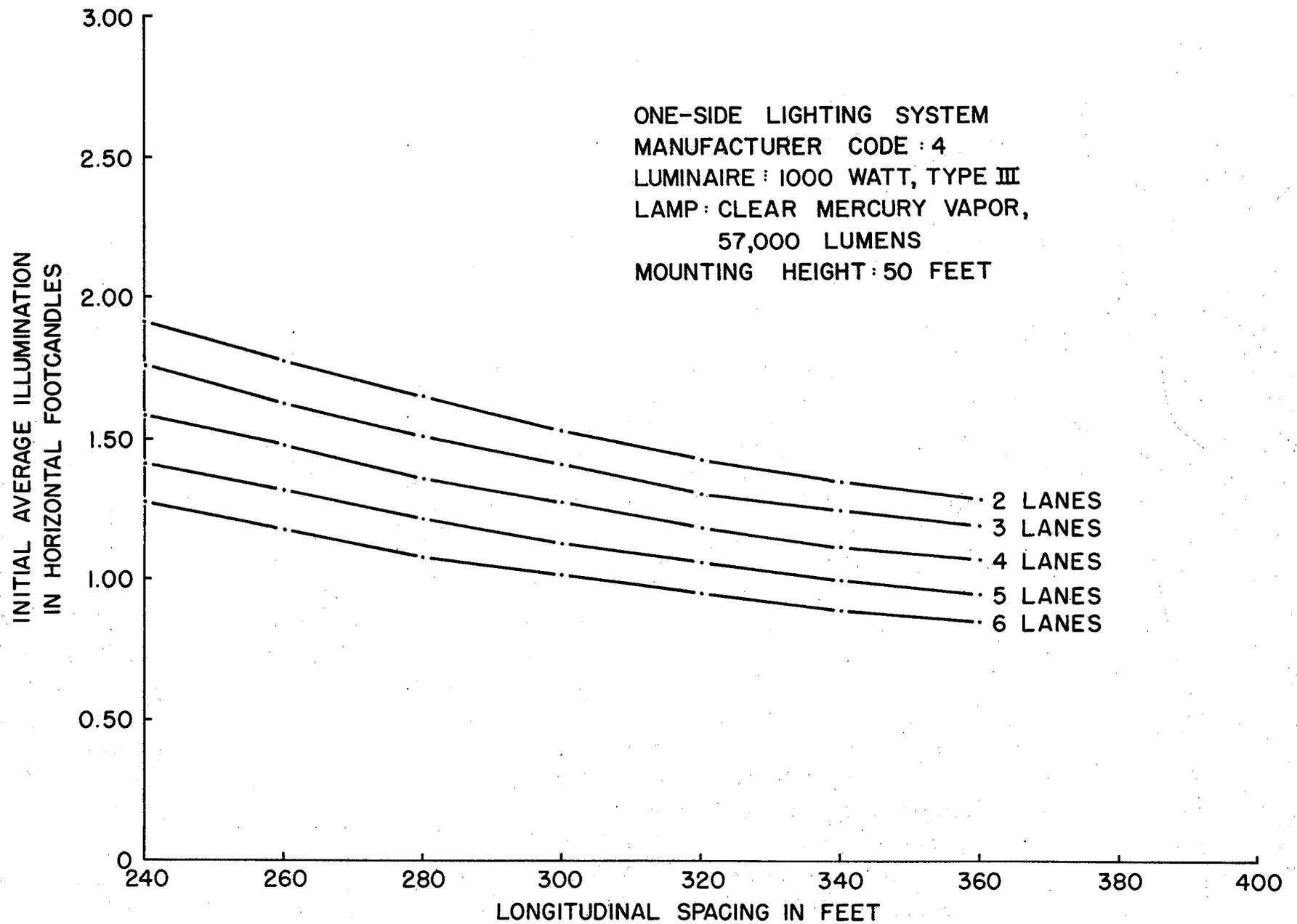
**FIGURE 27-INITIAL AVERAGE ILLUMINATION VS. LONGITUDINAL SPACING FOR DIFFERENT ROADWAY WIDTHS**
