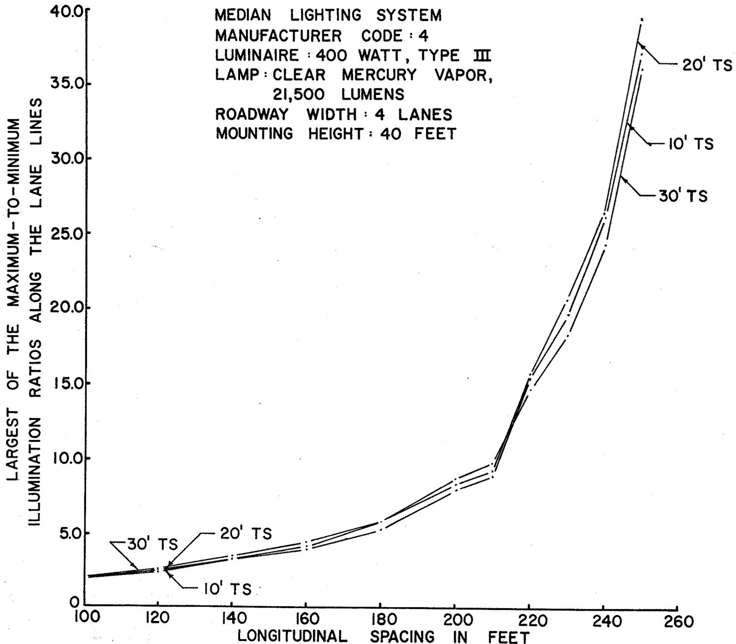
FIGURE 40-RATIO OF MAXIMUM TO MINIMUM ILLUMINATION VS. LONGITUDINAL SPACING FOR DIFFERENT TRANSVERSE SPACINGS
