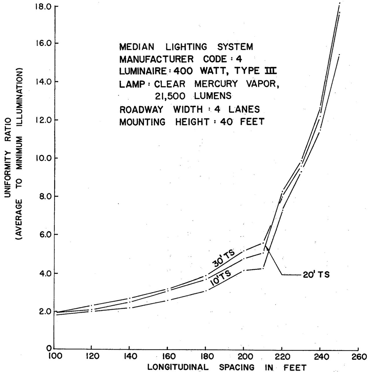
**FIGURE 7-UNIFORMITY RATIO VS. LONGITUDINAL SPACING FOR
