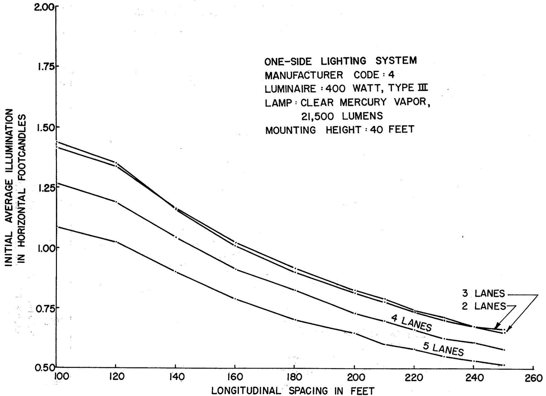
FIGURE 26-INITIAL AVERAGE ILLUMINATION VS. LONGITUDINAL SPACING FOR DIFFERENT ROADWAY WIDTHS
