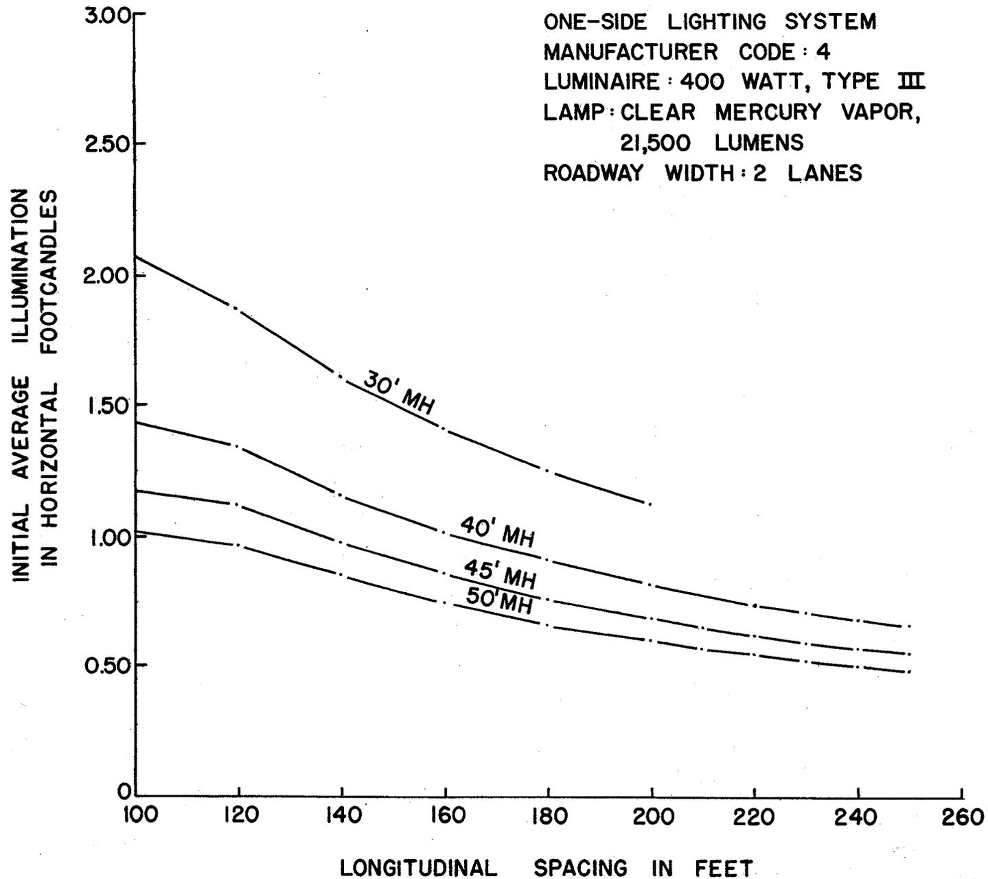
FIGURE 4—INITIAL AVERAGE ILLUMINATION VS. LONGITUDINAL SPACING FOR DIFFERENT MOUNTING HEIGHTS
