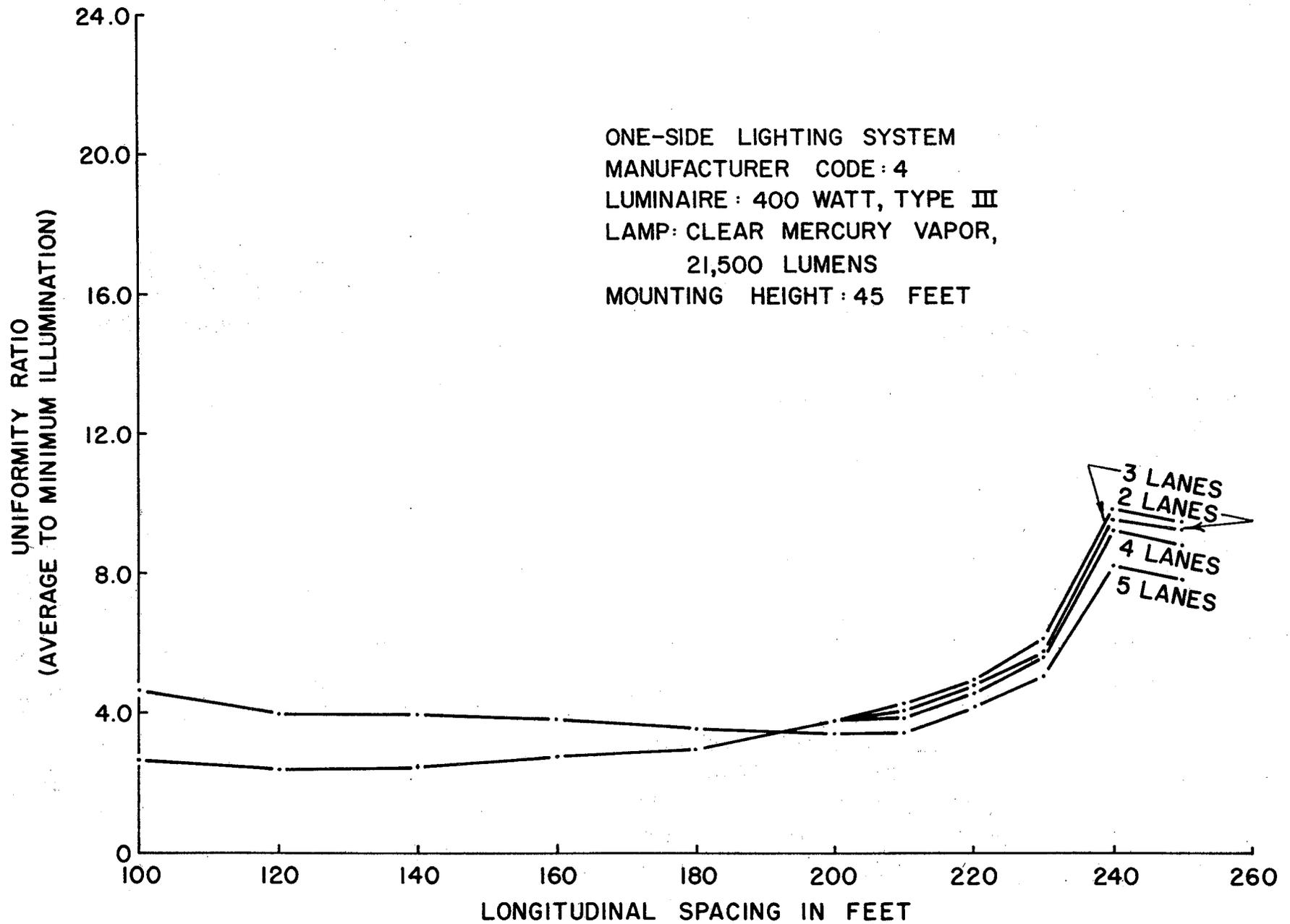
**FIGURE 30- UNIFORMITY RATIO VS. LONGITUDINAL SPACING FOR
