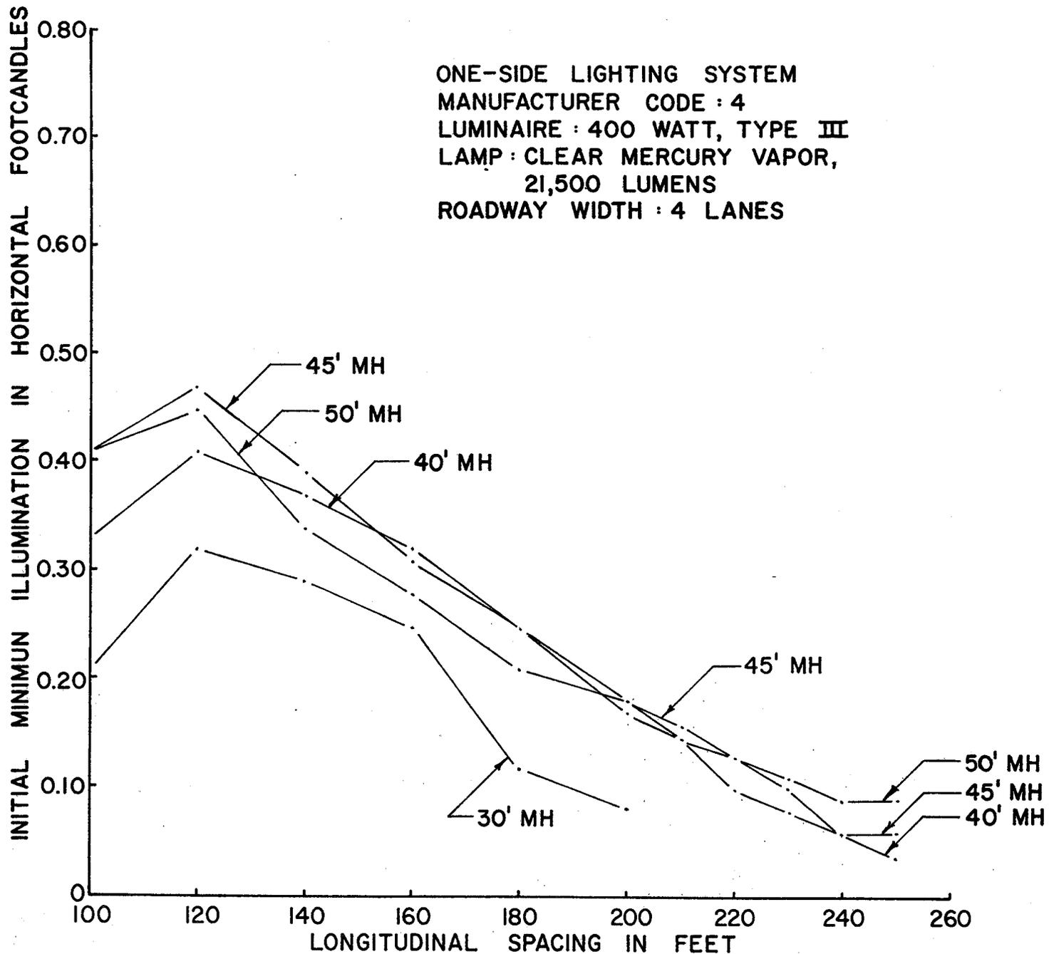
**FIGURE 36—INITIAL MINIMUM ILLUMINATION VS. LONGITUDINAL SPACING FOR DIFFERENT MOUNTING HEIGHTS**
