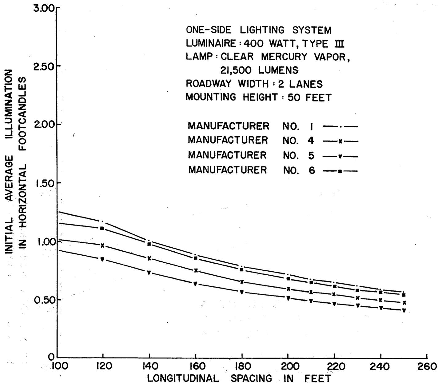
FIGURE 22—INITIAL AVERAGE ILLUMINATION VS. LONGITUDINAL SPACING FOR DIFFERENT MANUFACTURERS
