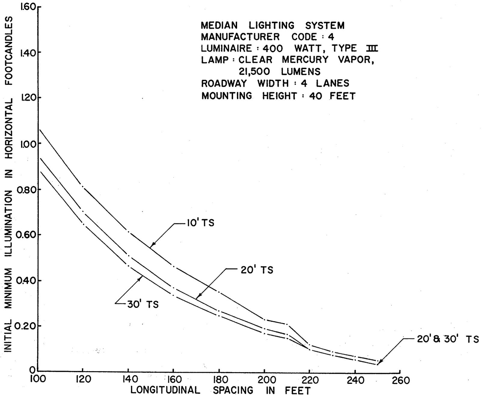
**FIGURE 38 - INITIAL MINIMUM ILLUMINATION VS. LONGITUDINAL SPACING FOR DIFFERENT TRANSVERSE SPACINGS**
