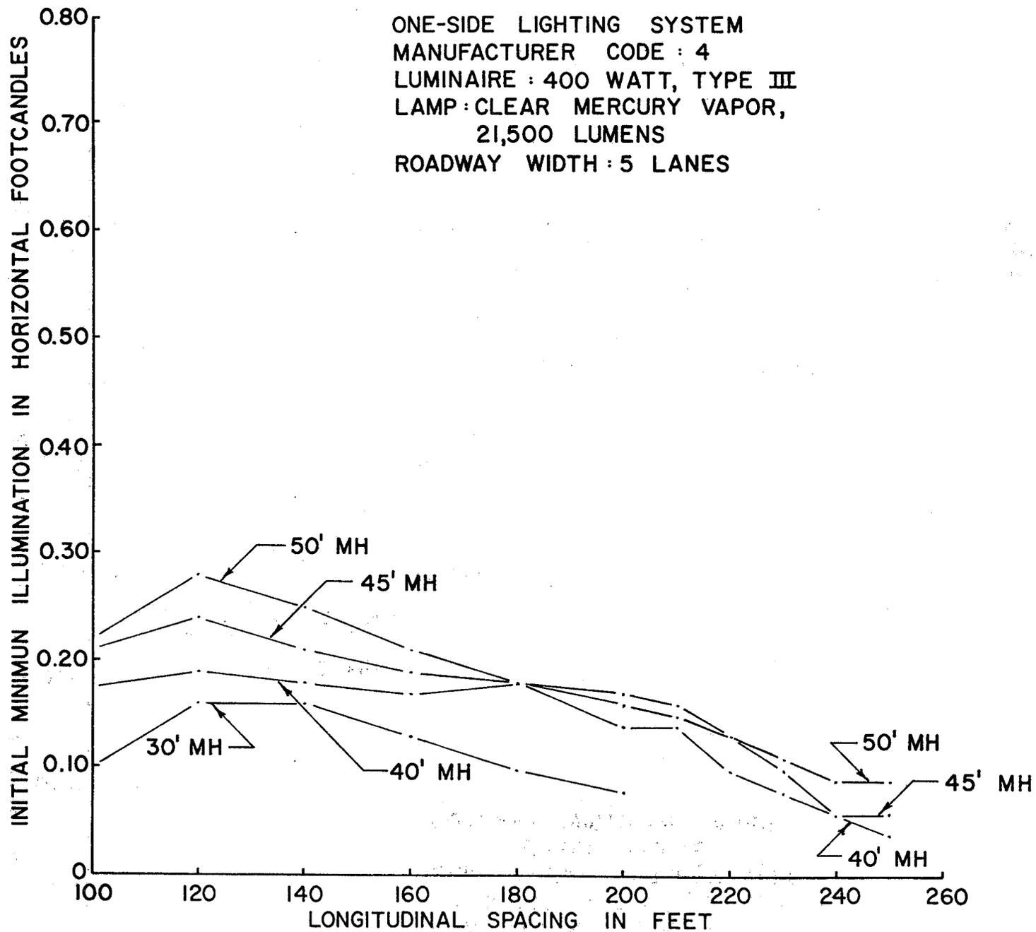
FIGURE 37—INITIAL MINIMUM ILLUMINATION VS. LONGITUDINAL SPACING FOR DIFFERENT MOUNTING HEIGHTS
