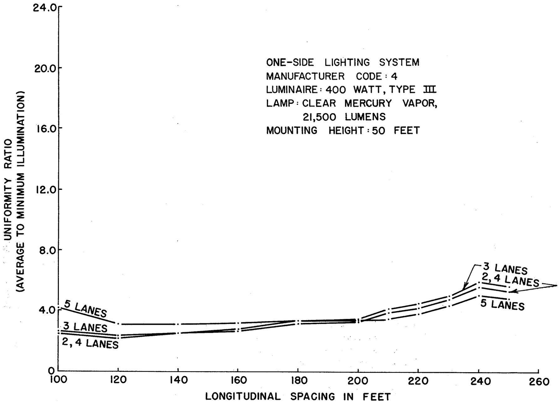
**FIGURE 31-UNIFORMITY RATIO VS. LONGITUDINAL SPACING FOR DIFFERENT ROADWAY WIDTHS**
