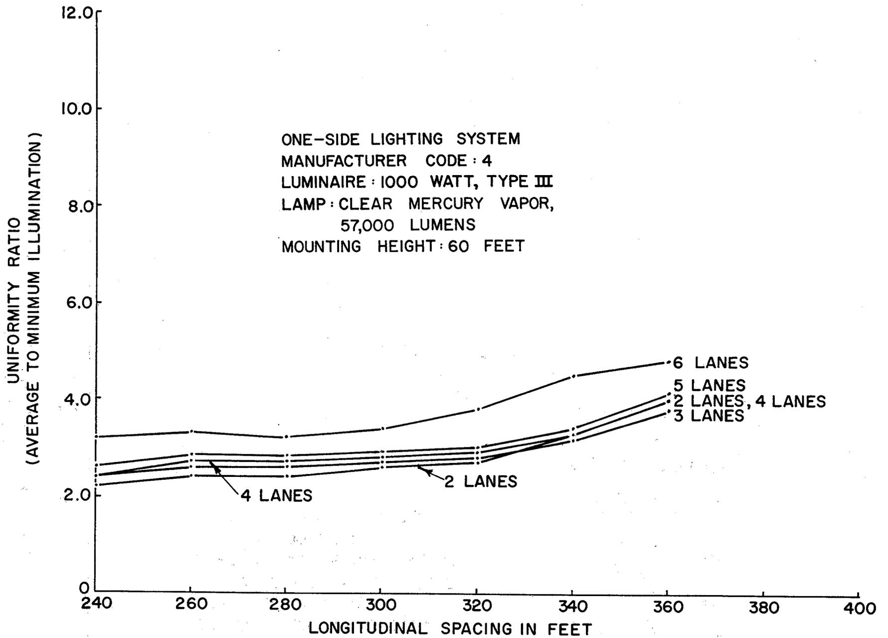
**FIGURE 33-UNIFORMITY RATIO VS. LONGITUDINAL SPACING FOR
