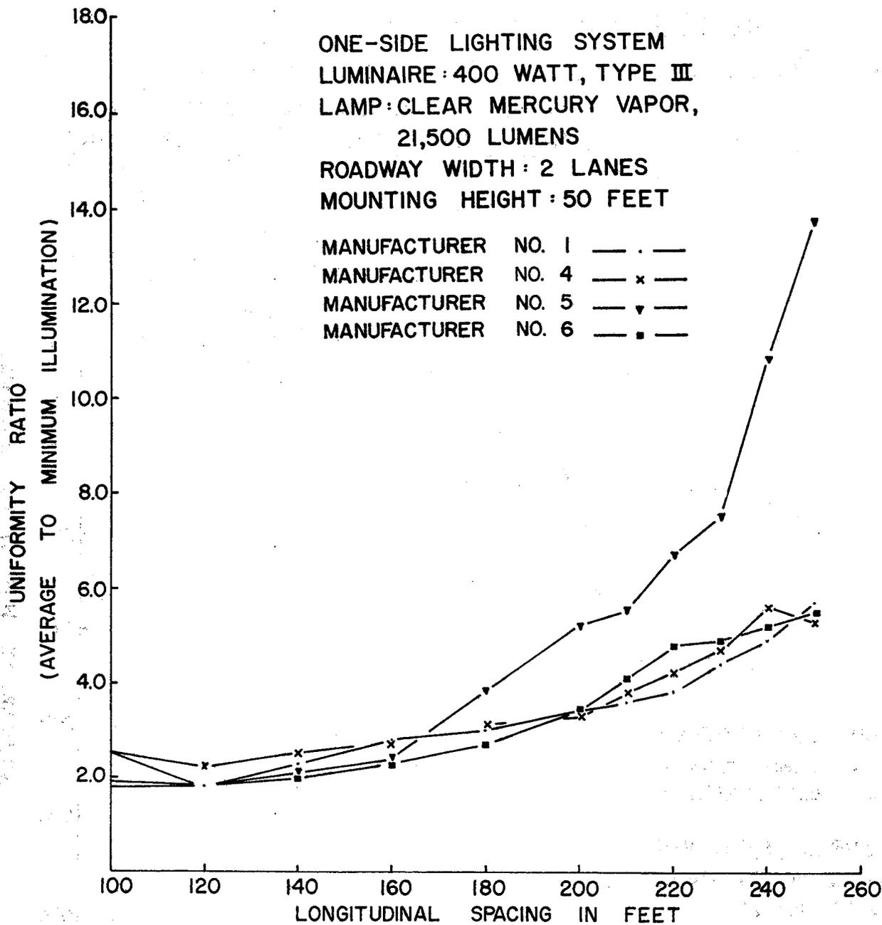
**FIGURE 24—UNIFORMITY RATIO VS. LONGITUDINAL SPACING FOR
