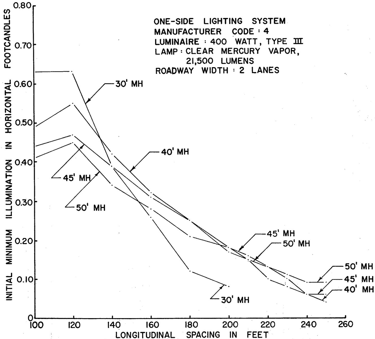
FIGURE 34—INITIAL MINIMUM ILLUMINATION VS. LONGITUDINAL SPACING FOR DIFFERENT MOUNTING HEIGHTS
