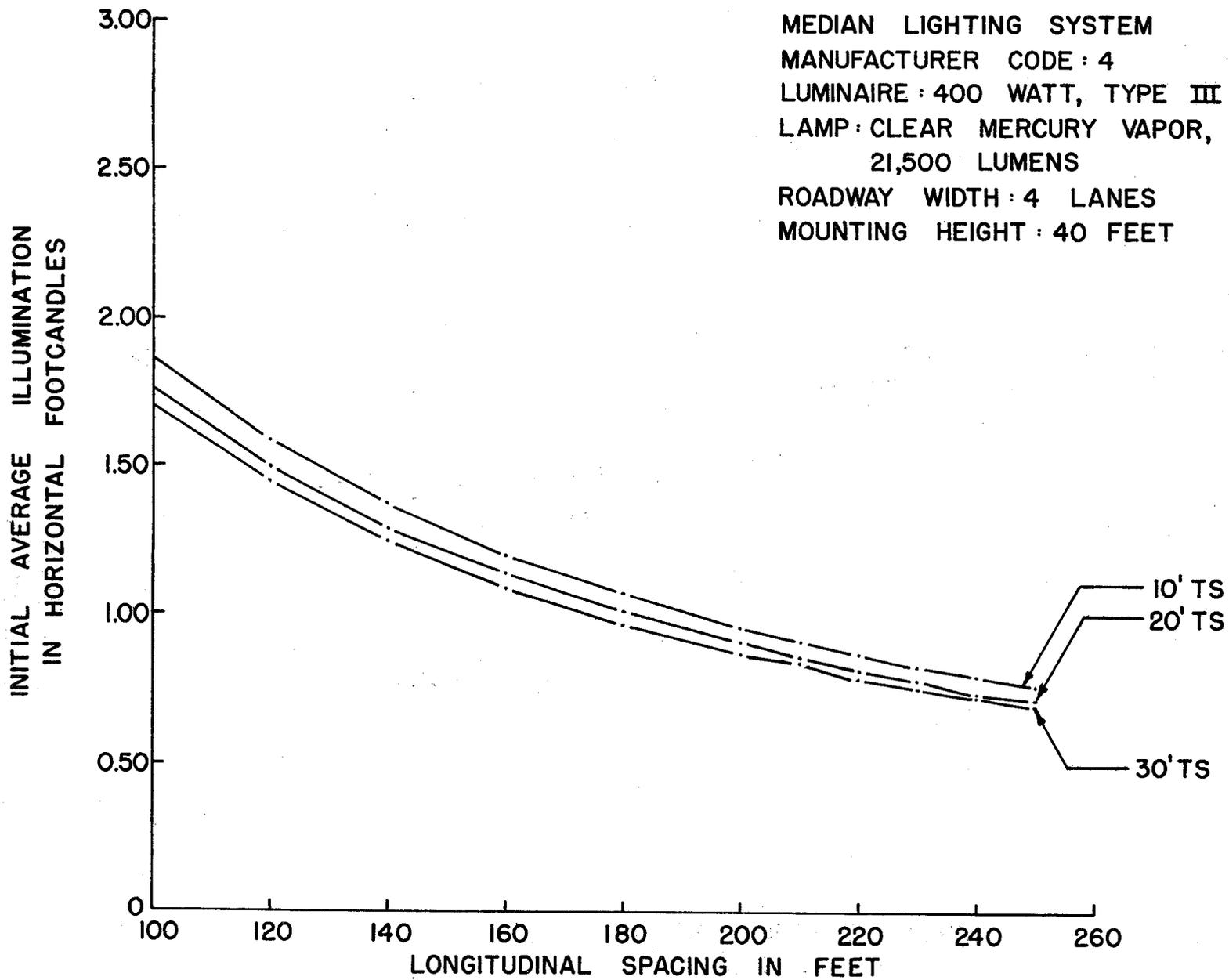
FIGURE 5—INITIAL AVERAGE ILLUMINATION VS. LONGITUDINAL SPACING FOR DIFFERENT TRANSVERSE SPACINGS
