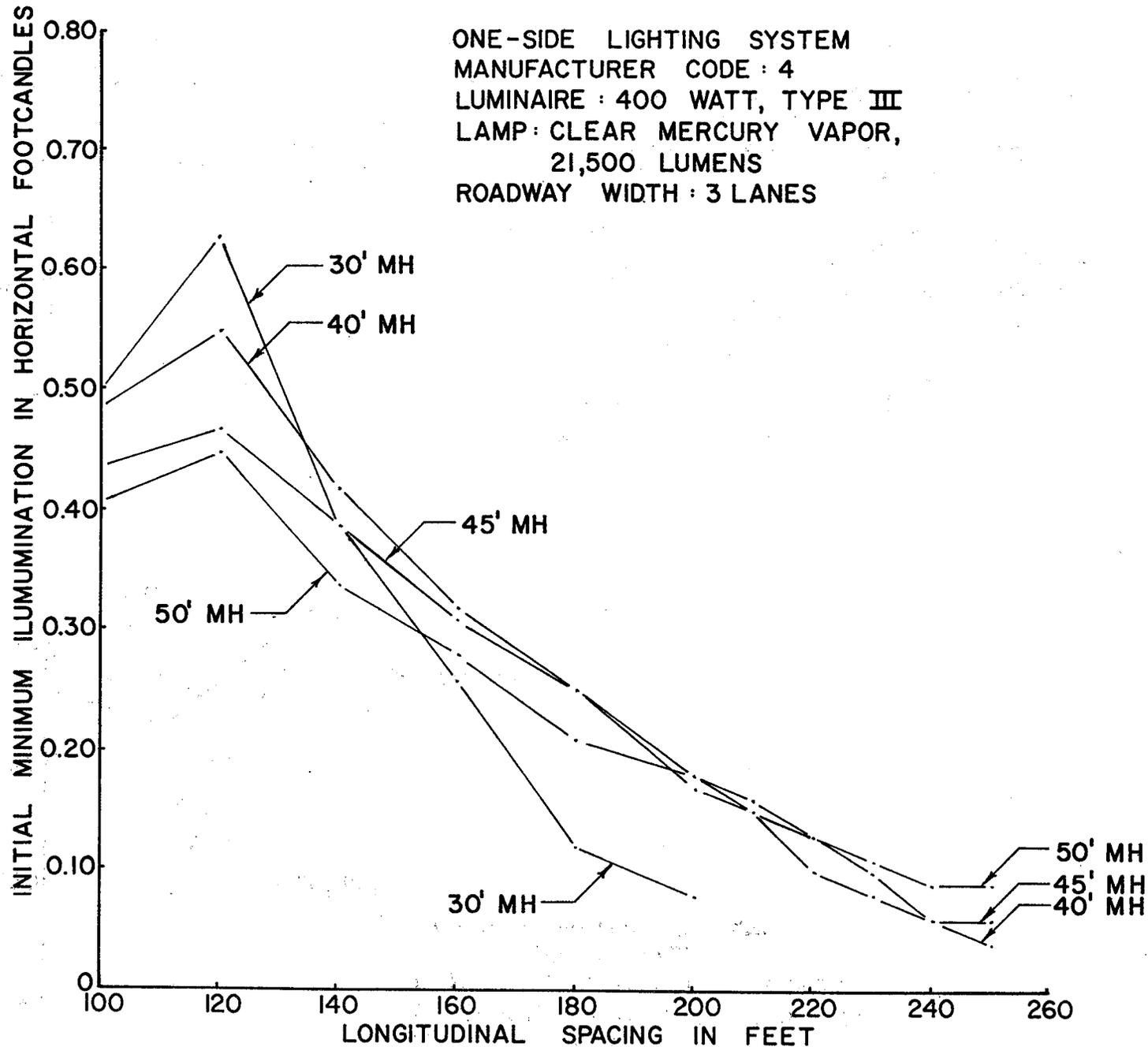
FIGURE 35—INITIAL MINIMUM ILLUMINATION VS. LONGITUDINAL SPACING FOR DIFFERENT MOUNTING HEIGHTS
