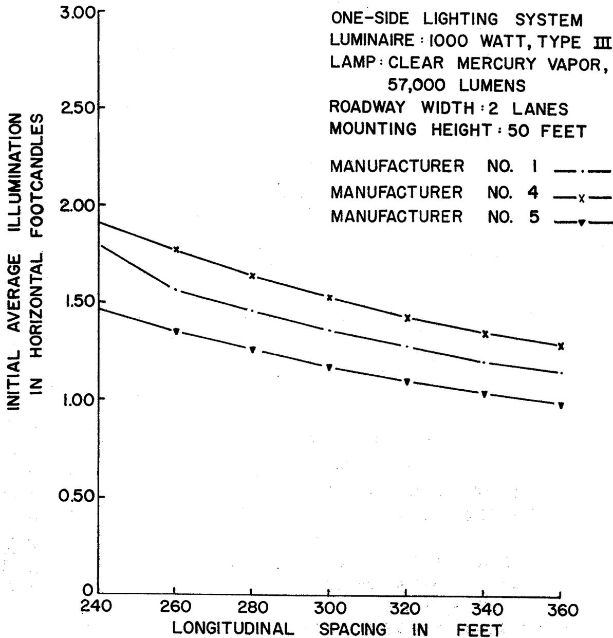
FIGURE 23— INITIAL AVERAGE ILLUMINATION VS. LONGITUDINAL SPACING FOR DIFFERENT MANUFACTURERS
