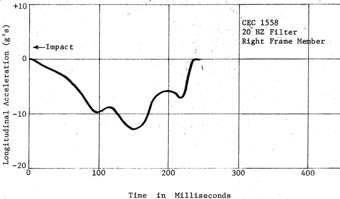
Figure A1, Longitudinal Accelerometer Data, Test 1146-6
