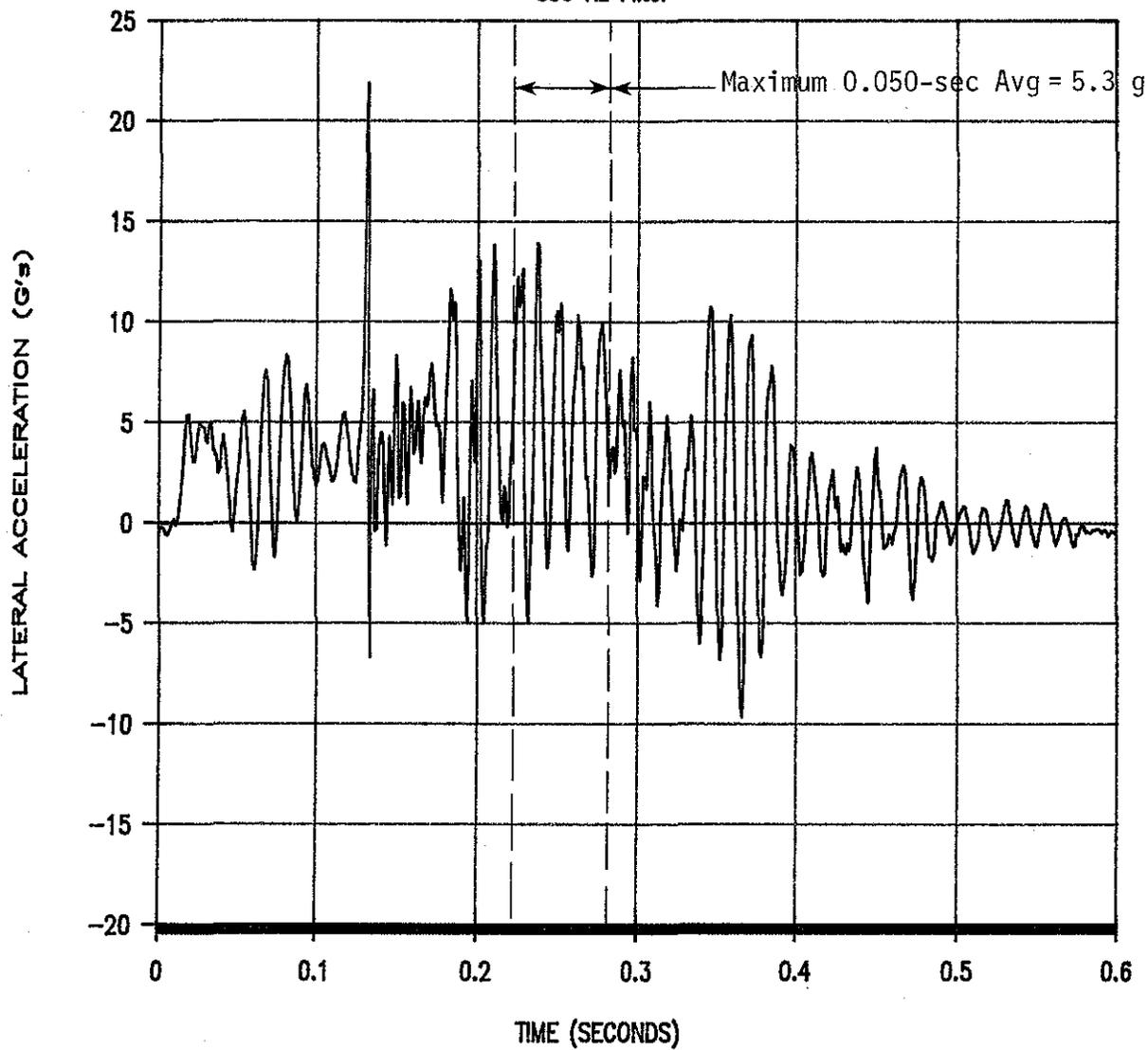
FIGURE B-14. LATERAL ACCELEROMETER TRACE FROM TEST 1147-5.
