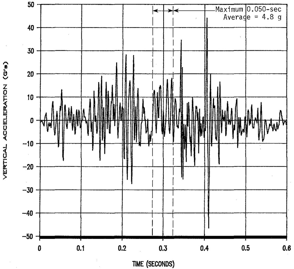
FIGURE B-12. VERTICAL ACCELEROMETER TRACE FROM TEST 1147-4.
