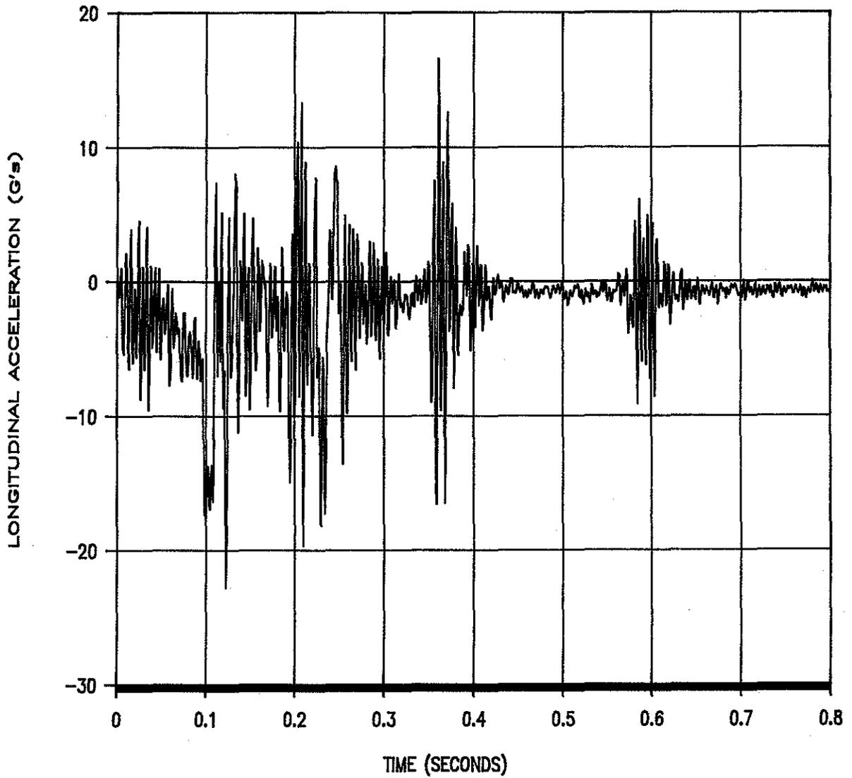
FIGURE B-1. LONGITUDINAL ACCELEROMETER TRACE FROM TEST 1147-1.
