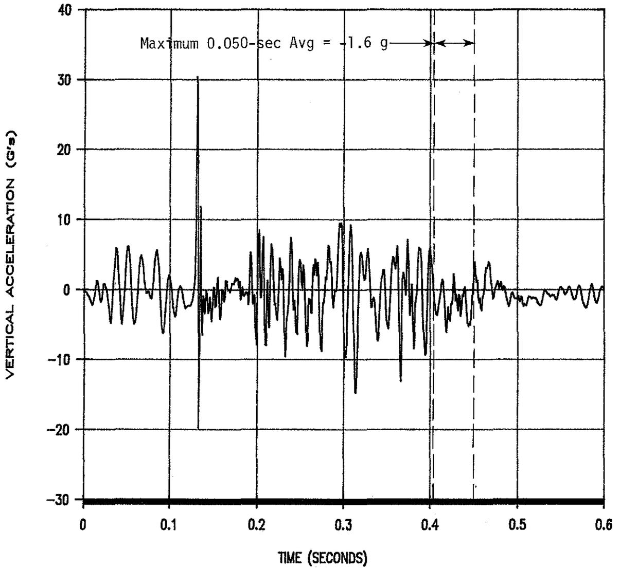
FIGURE B-15. VERTICAL ACCELEROMETER TRACE FROM TEST 1147-5.
