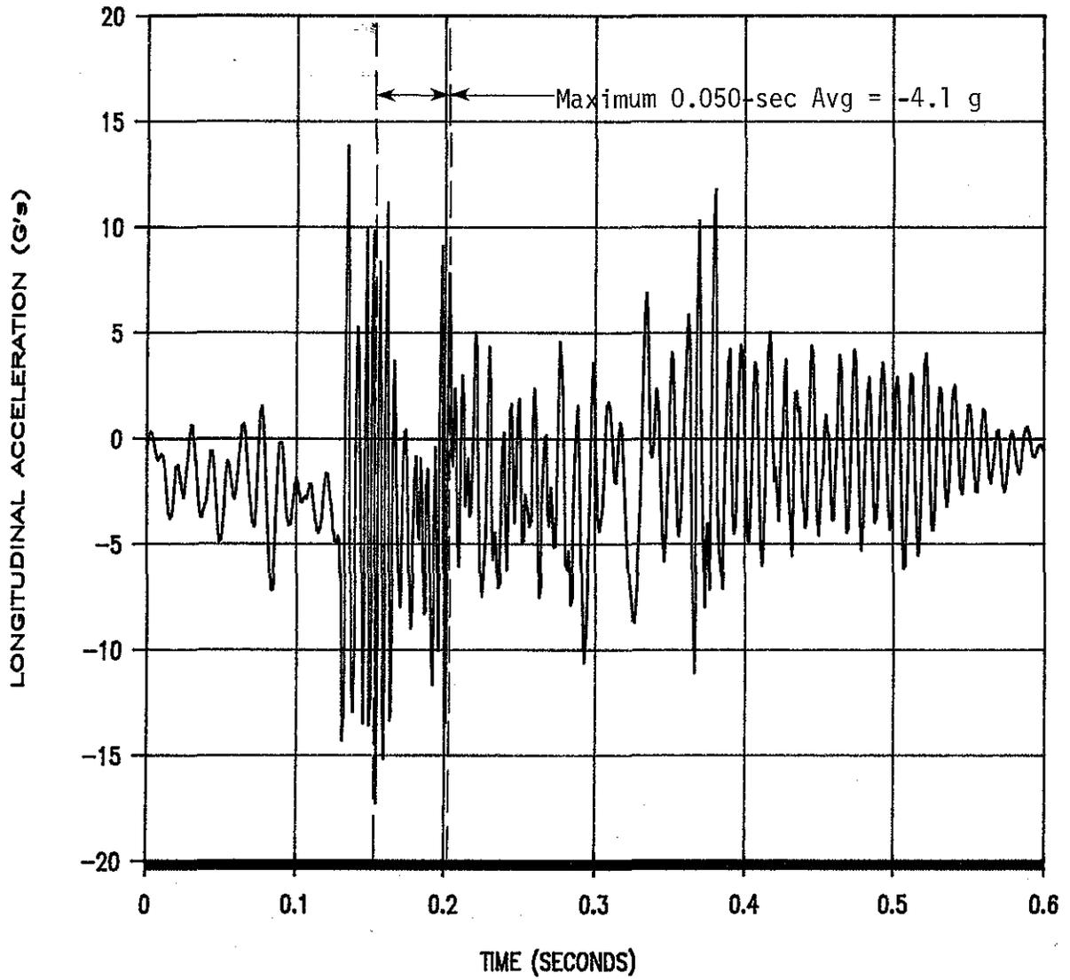
FIGURE B-13. LONGITUDINAL ACCELEROMETER TRACE FROM TEST 1147-5.
