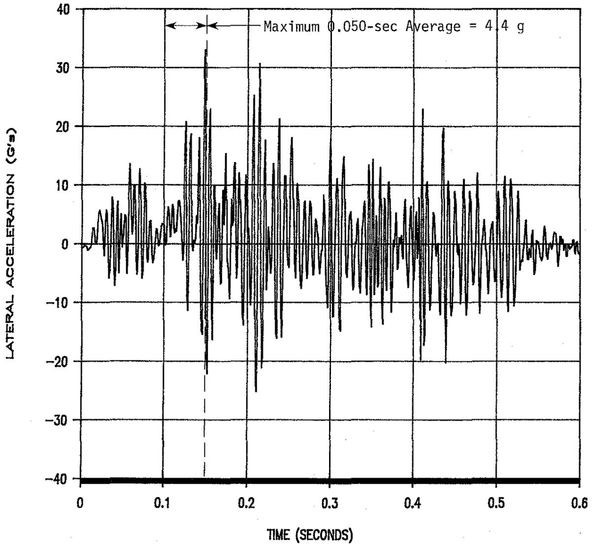
FIGURE B-11. LATERAL ACCELEROMETER TRACE FROM TEST 1147-4.
