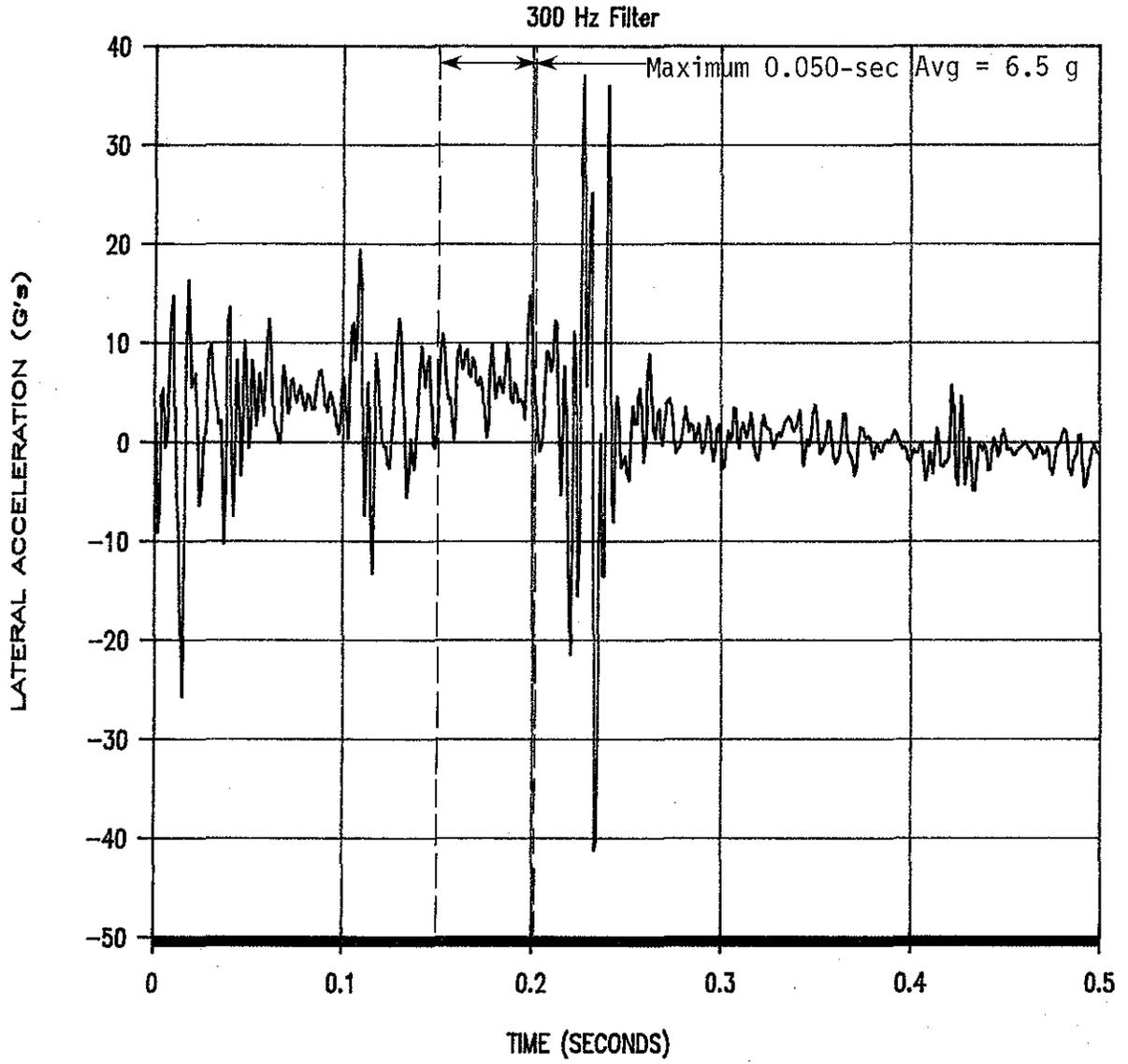
FIGURE B-8. LATERAL ACCELEROMETER TRACE FROM TEST 1147-3.
