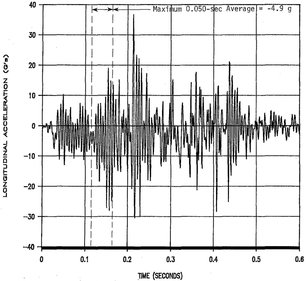
FIGURE B-10. LONGITUDINAL ACCELEROMETER TRACE FROM TEST 1147-4.
