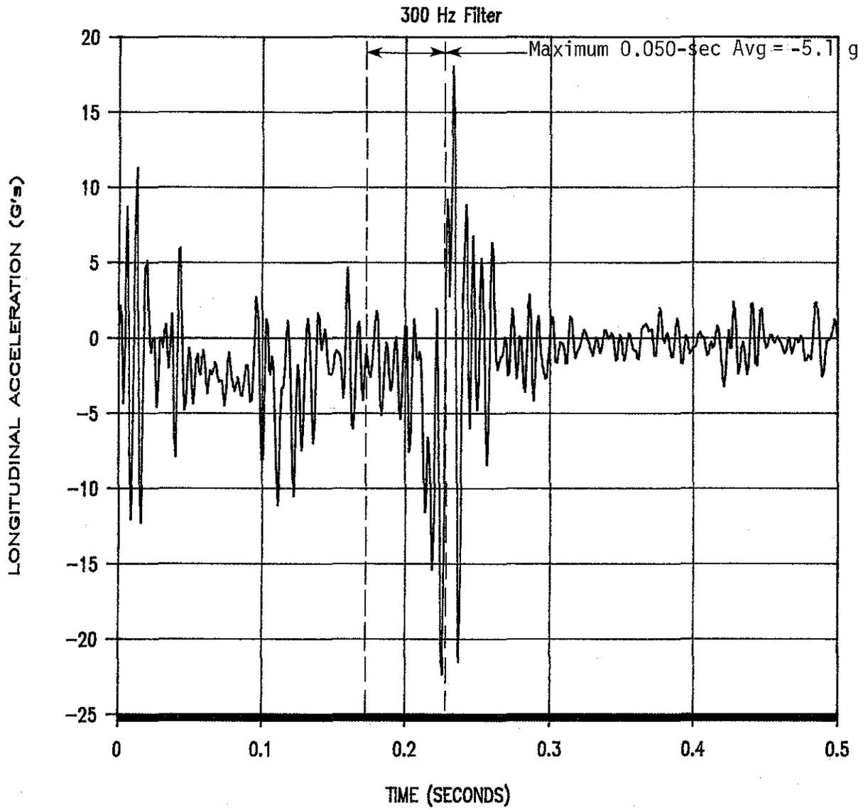
FIGURE B-7. LONGITUDINAL ACCELEROMETER TRACE FROM TEST 1147-3.
