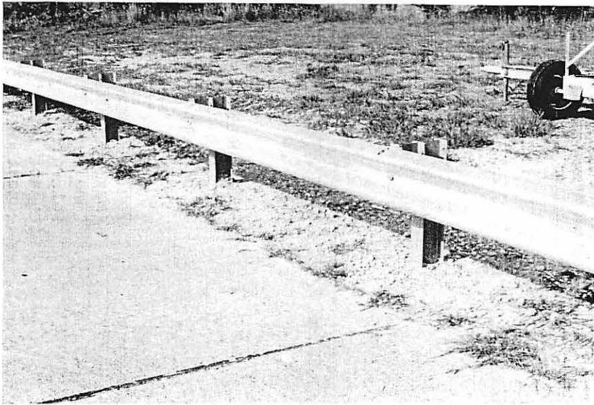
FIGURE 9. OPTIMIZED GUARD FENCE DESIGN WITH W6X9 STEEL POSTS.
