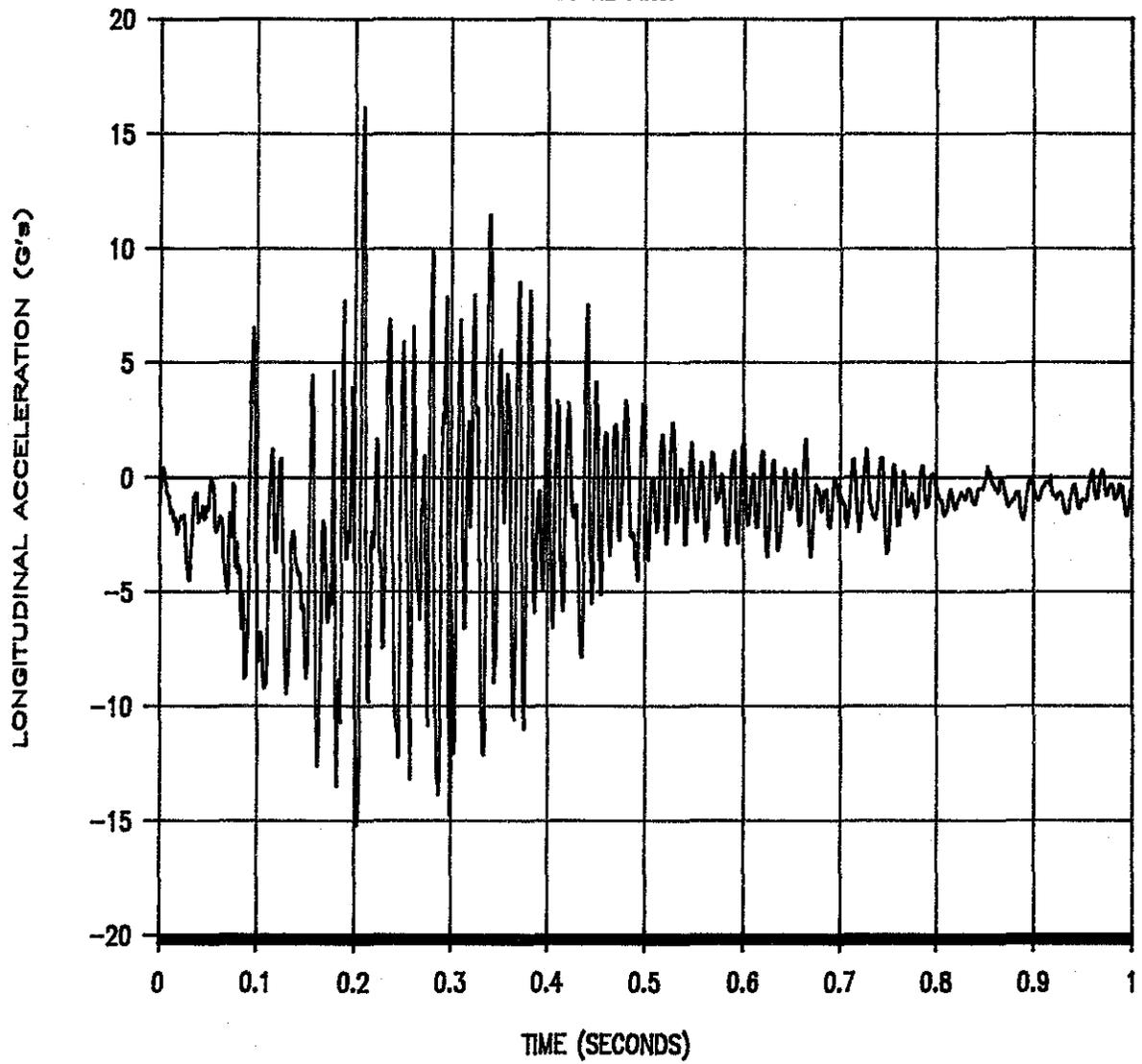
FIGURE B-4. LONGITUDINAL ACCELEROMETER TRACE FROM TEST 1147-2.
