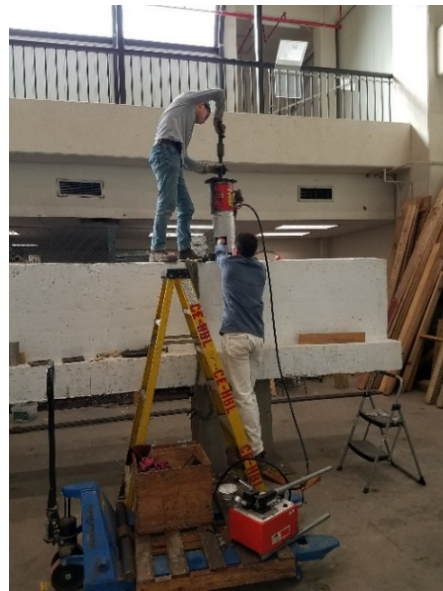
(d) Stressing Dywidag bar to clamp specimen to floor
