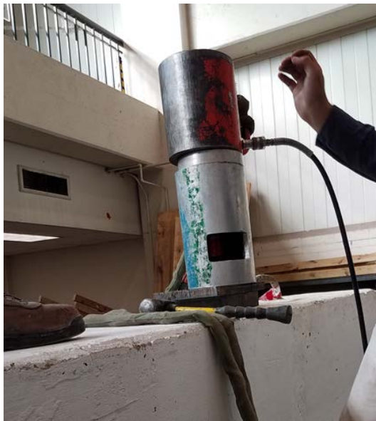
(d) Stressing Dywidag bar to clamp specimen to floor
