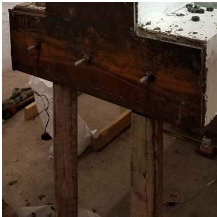
(d) Place the end plate and hold from bottom
