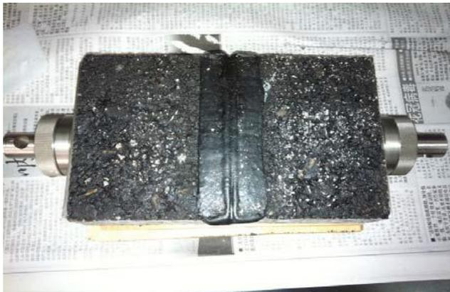
**Seal Band Test Specimen**
