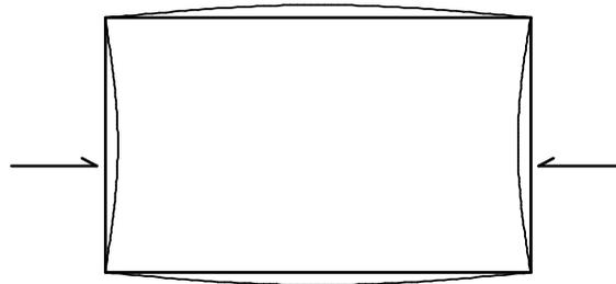
FIGURE 2.7. CULVERT DEFORMATION DUE TO LATERAL LOAD ONLY
