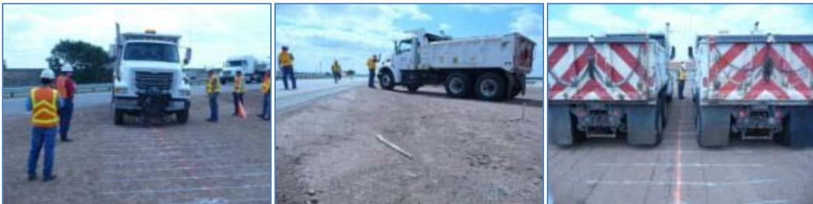
FIGURE 6.3. LIVE LOAD CONFIGURATIONS: A) TRUCK STRADDLING GAGE LINE B) WHEEL ON GAGE LINE C) 2 TRUCKS STRADDLING GAGE LINE.
