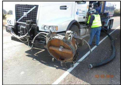
(d) Truck mounted UHP water cutting unit
