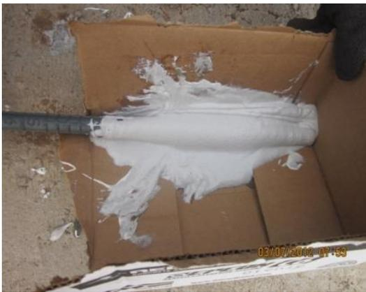
Figure 3.3- (d) Put rebar into epoxy
