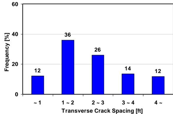
(d) Crack Spacing Distributions for Regular Section
