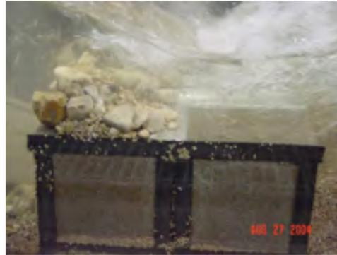
(d) Deposition on top of culvert.
