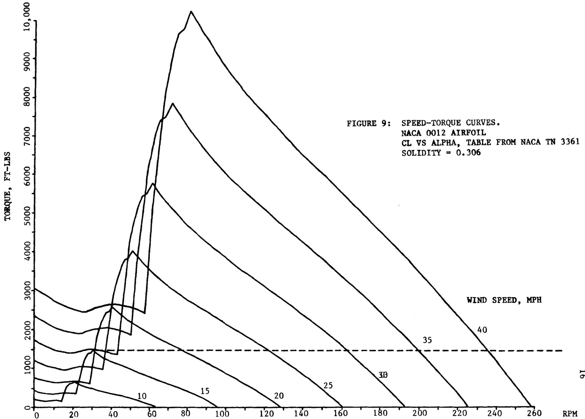
FIGURE 9: SPEED-TORQUE CURVES.
