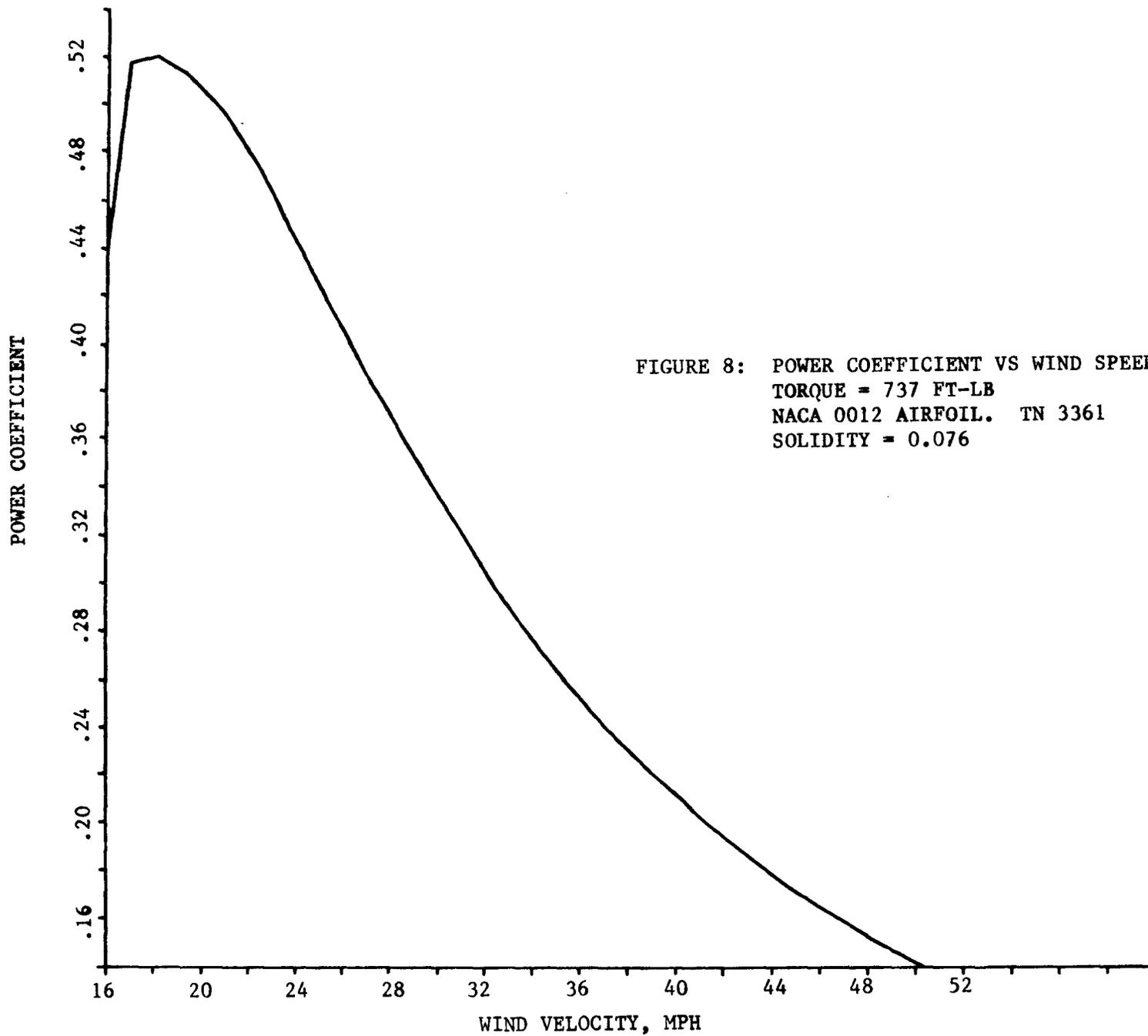
FIGURE 8: POWER COEFFICIENT VS WIND SPEED.
