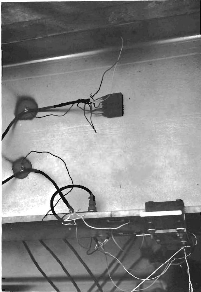
FIGURE 7 SR-4 STRAIN GAGES ATTACHED TO BEAM
