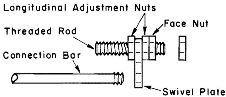
TRANSVERSE, VERTICAL, AND LONGITUDINAL ALIGNMENT
