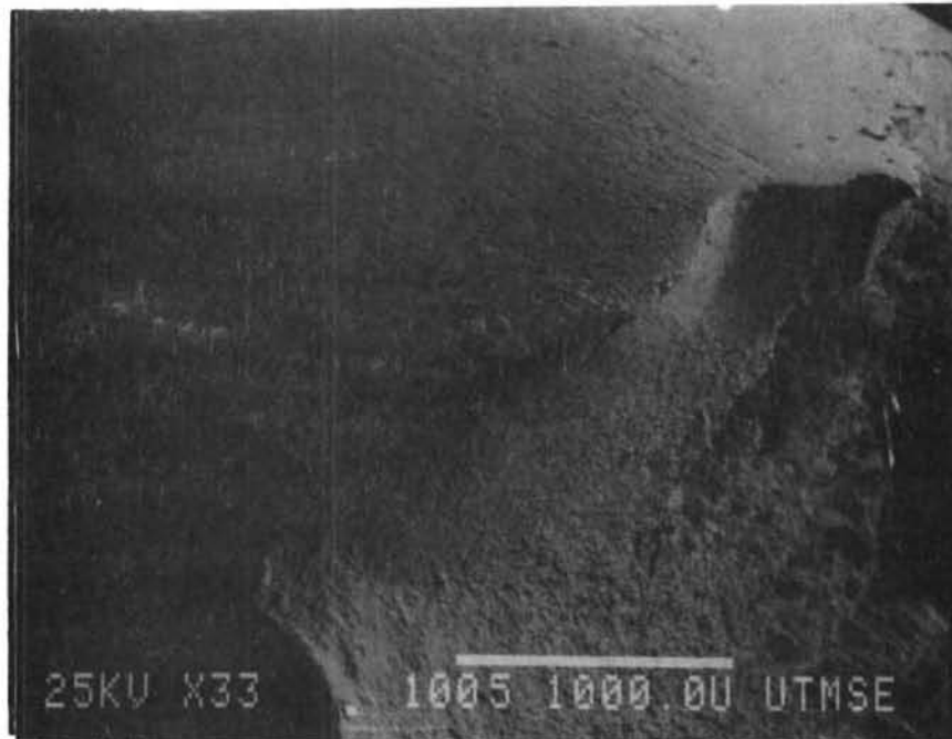
Fig. 6.10 Crack initiation site
