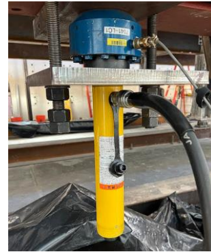
(d) Mounted hydraulic ram and load cell
