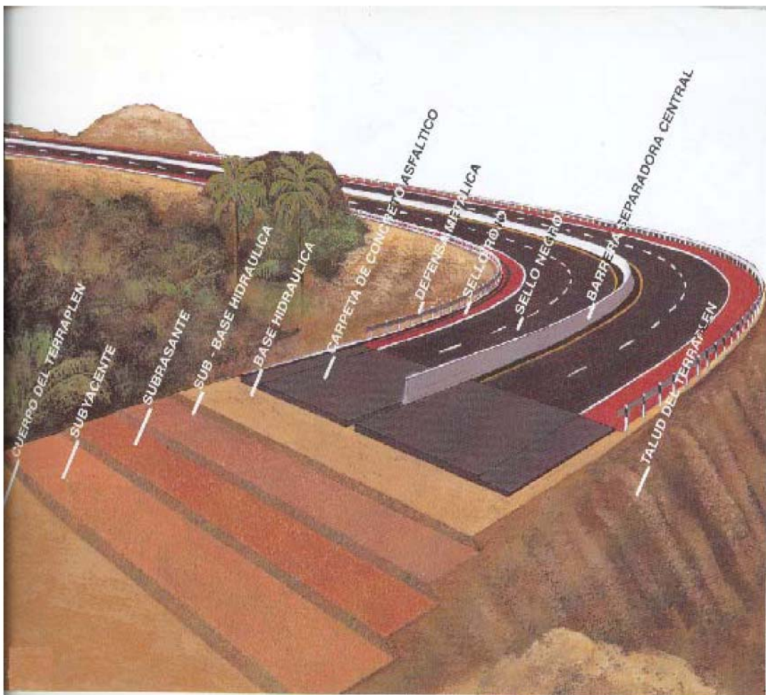
Sección típica de un terraplén
