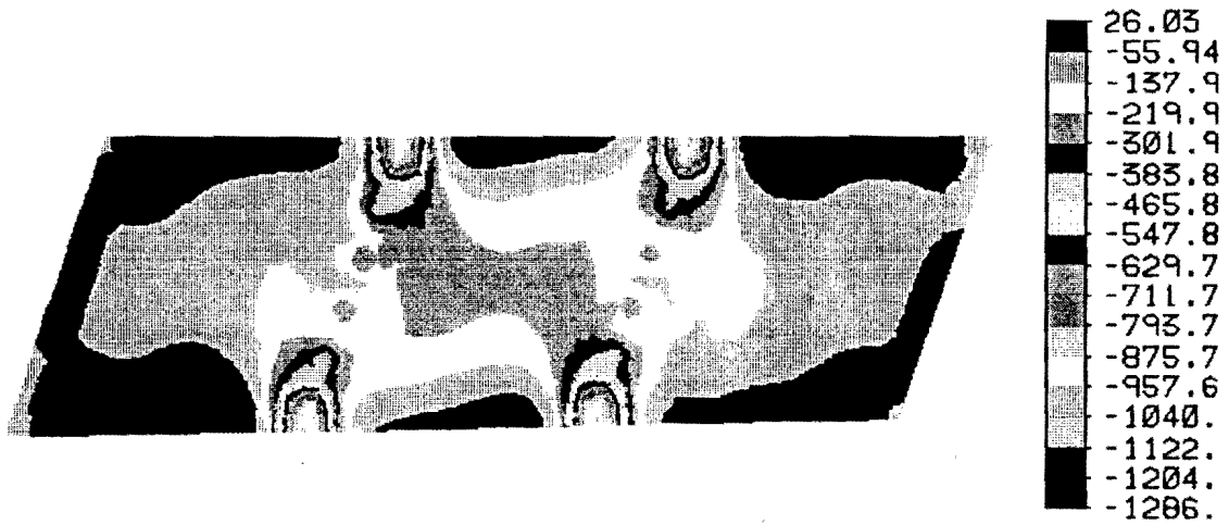
FIG. 51. FEM Transverse Bottom Layer Stresses at 56 Days after Pour
