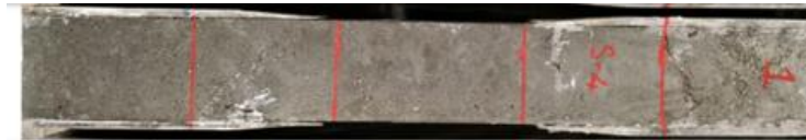
(d) Specimen 04 cracked within the grips
