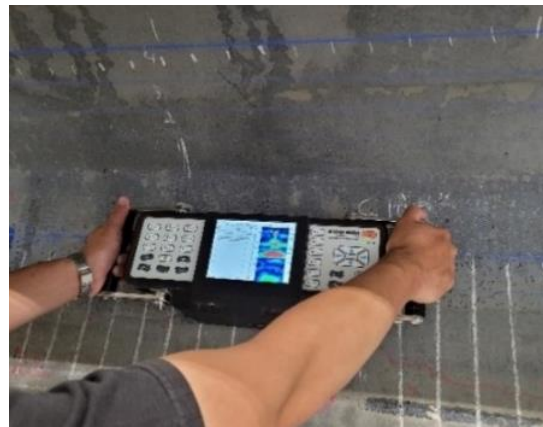
(d) Ultrasonic Tomography in Progress
