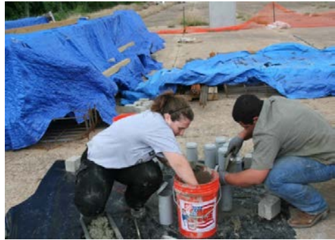
(d) Cylinder Specimens
