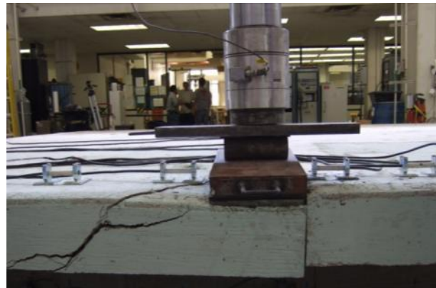
(d) Specimen 2 lab-cast overhang failure load
