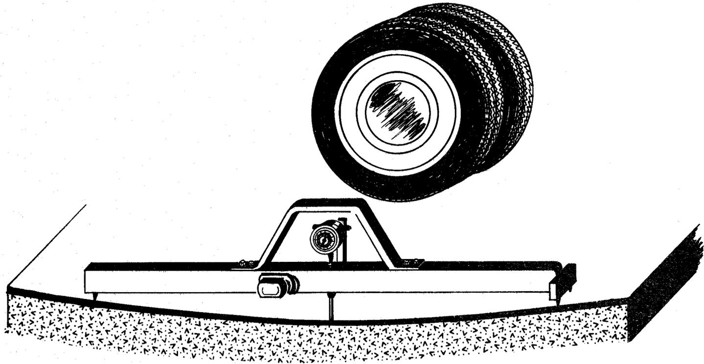
CURVATURE BEAM IN OPERATION
