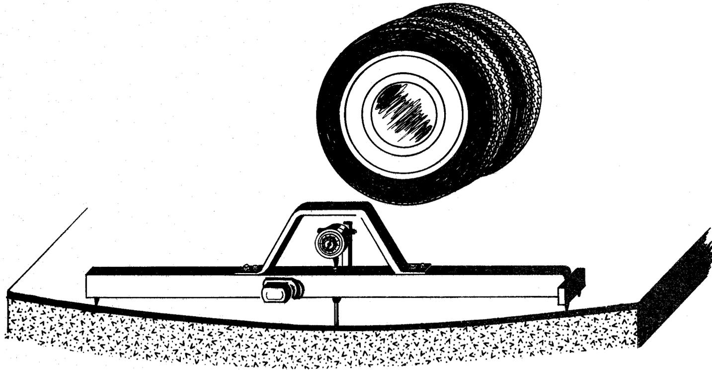
CURVATURE BEAM IN OPERATION
