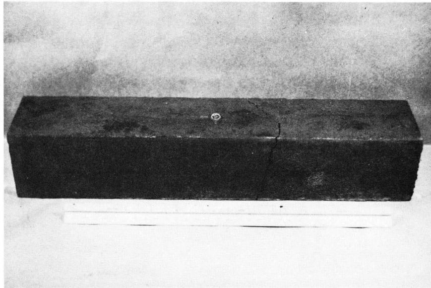
a. Stress Amplitude Failure
