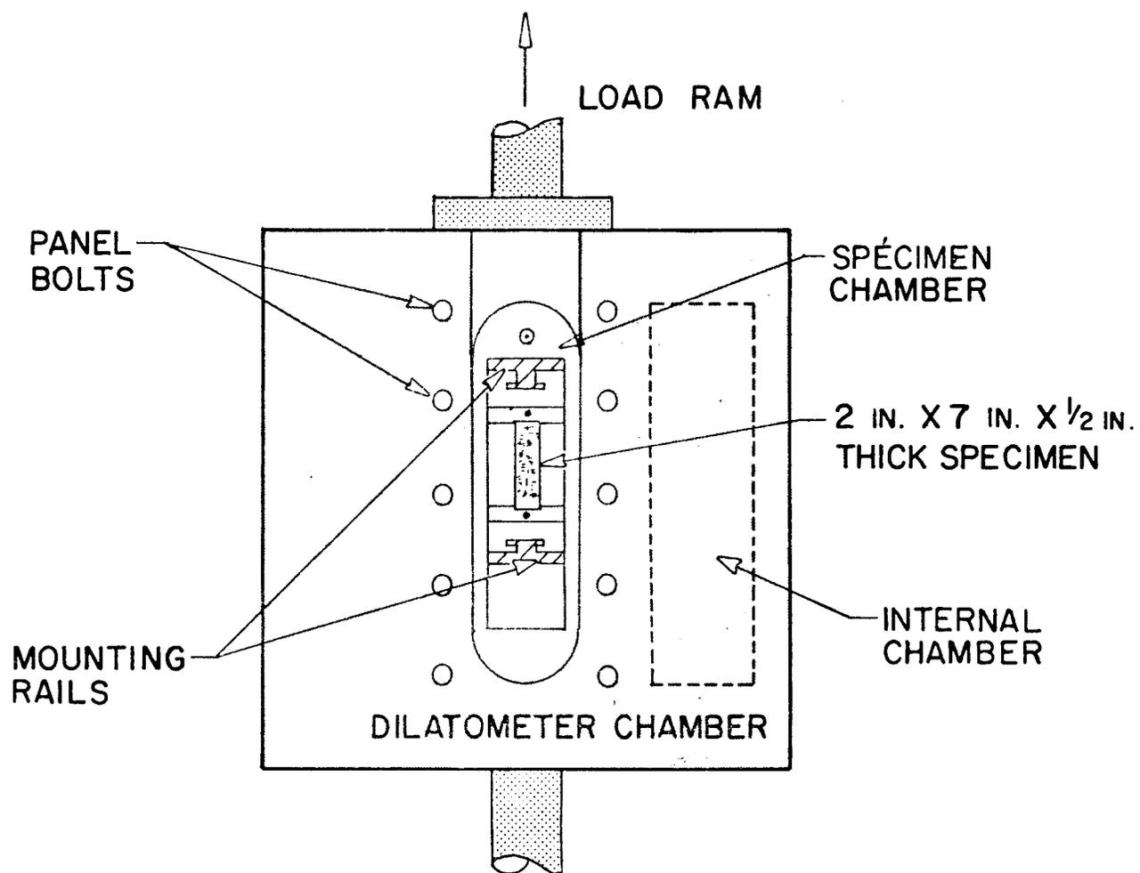
Fig. 12. Gas dilatometer.
