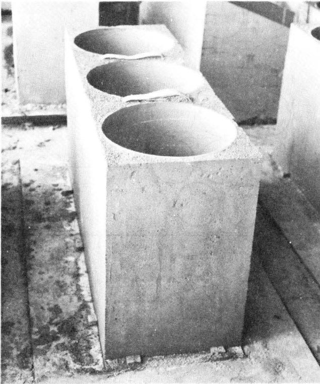
FIGURE IV.2.D.5. PRECAST VERMICULITE MODULE.
