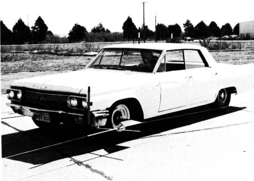
FIGURE A.3. GUIDANCE SYSTEM ATTACHED TO VEHICLE BEFORE TEST
