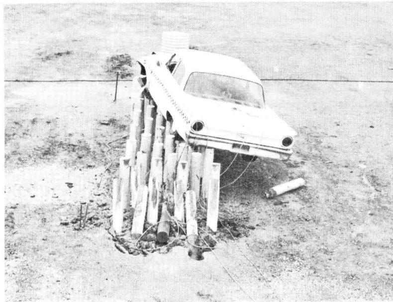
FIGURE IV.1.C.3. POSTS AND VEHICLE AFTER COLLISION
