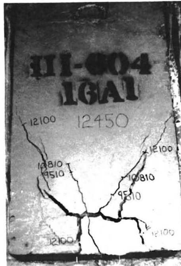
(d) Ultimate failure at 12.45 kips.
