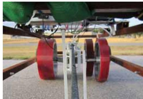
(d) SD: 12.5-in. Diameter Wheels: Two, 2-in. and One, 4-in. Wide Treads
